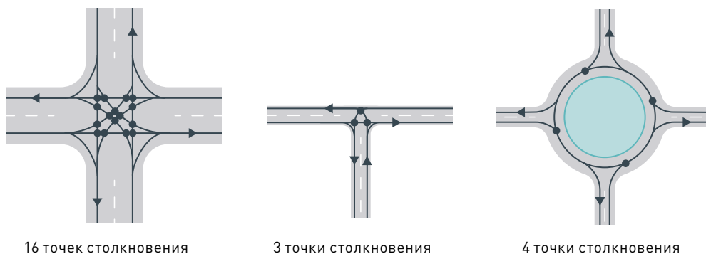
Илл. 151. Количество точек столкновения на X-образных, T-образных и кольцевых пересечениях
