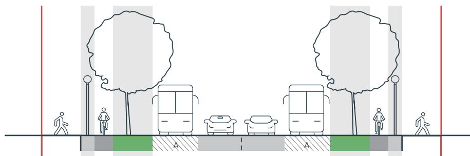
Илл. 12. Профиль улицы без буферной полосы между полосами проезжей части встречного направления
