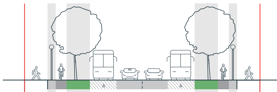
Илл. 30. Профиль улицы без буферной полосы между полосами проезжей части встречного направления
